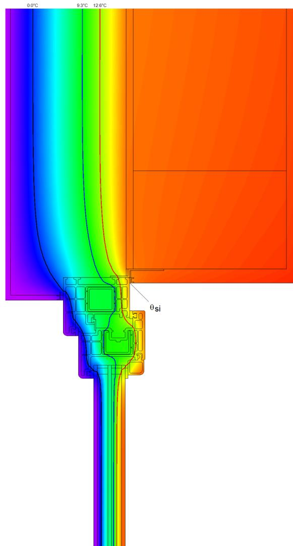
**Bild 5** Detail Isothermenverlauf seitlicher Anschluss
