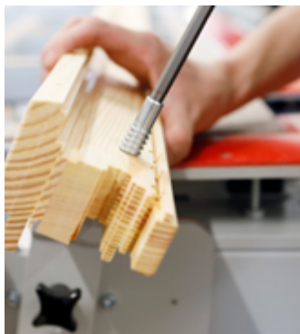
Die MC2 Hülse gibt die Positionierung bei der Verbindung der Ecken vor und sorgt mit ihrem massiven Schaft für die Aufnahme hoher Scherkräfte.
