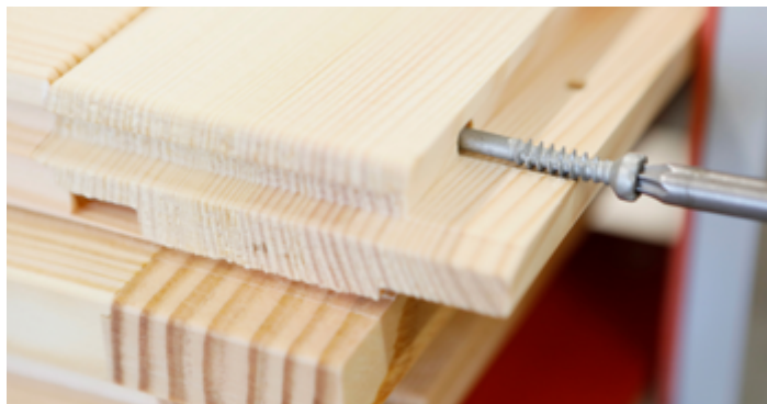
Durch die unterschiedlichen Gewindesteigungen erzeugt der MC1 Eckverbinder eine hohe Vorspannkraft, welche ein Dübel nicht aufbringen kann. So hält er die Brüstungsfuge beim Schwinden und Quellen dauerhaft geschlossen.
