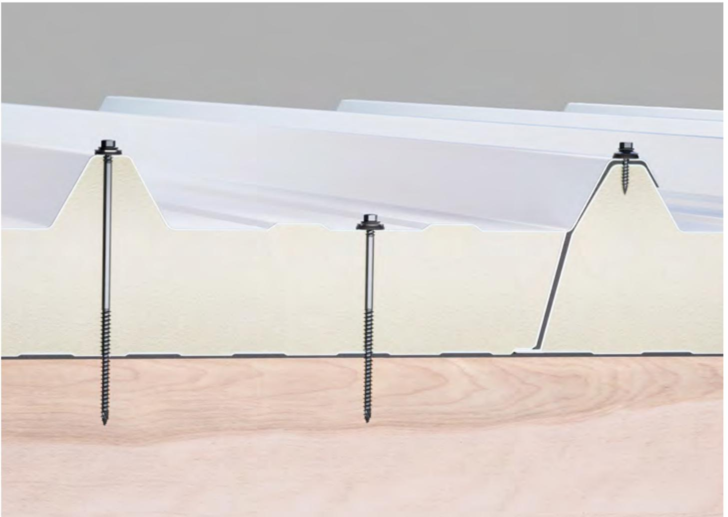
**Befestigung von Sandwichelemente in einem Arbeitsgang: Die SXC-Bohrbefestiger von SFS sind speziell für die hohen Anforderungen bei Sandwich-Systemen entwickelt worden. Dynamische Belastungen durch Temperatureinwirkungen, Begehen oder Windlasten haben keine negativen Auswirkungen auf die Funktionalität der Befestigungen. Stützgewinde, gewindefreie Zone und die abgestimmte Dichtscheibe ergeben eine dauerhaft dichte Verbindung.**
