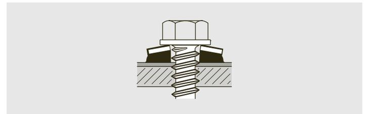
**Hohes Risiko von Undichtheiten** durch geringeres Komprimieren des dünnen EPDM.
