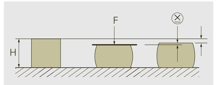
**Geringe Dichtheit** weil der innere Durchmesser des EPDM größer ist als der Gewindedurchmesser.
