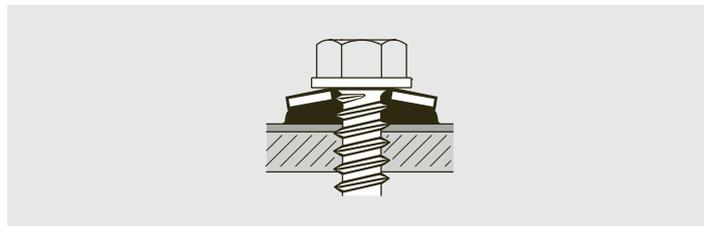
**Minimales Risiko von Undichtheiten** durch optimales Komprimieren des dicken EPDM.
